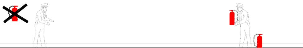
Una volta usato, l'estintore va sostituito con uno identico pieno.
